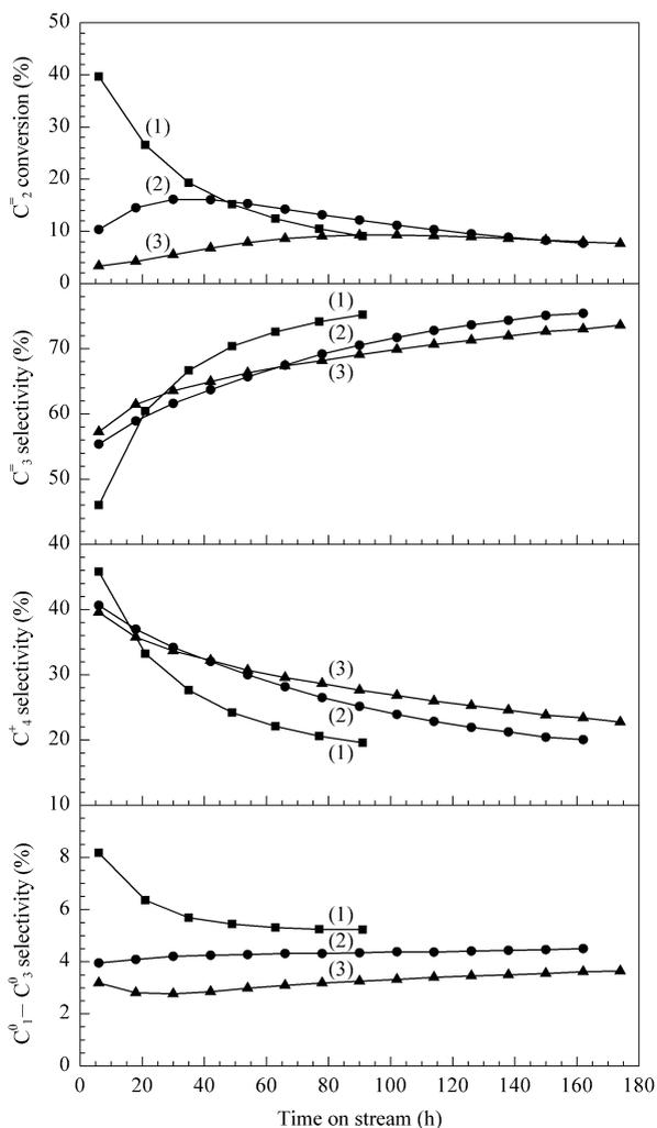
图 4 400 °C 下稀释比对乙烯转化率和产物选择性的影响
